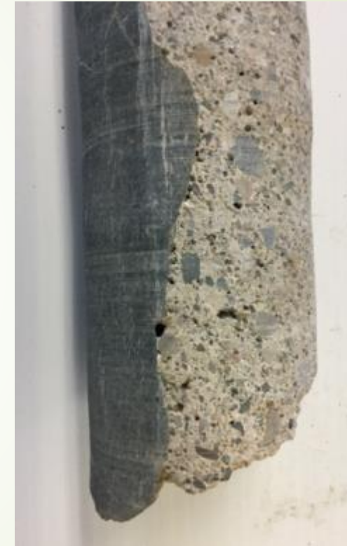
Vides d'air autour d'un granulat de 68,5 mm dans la CR-14
