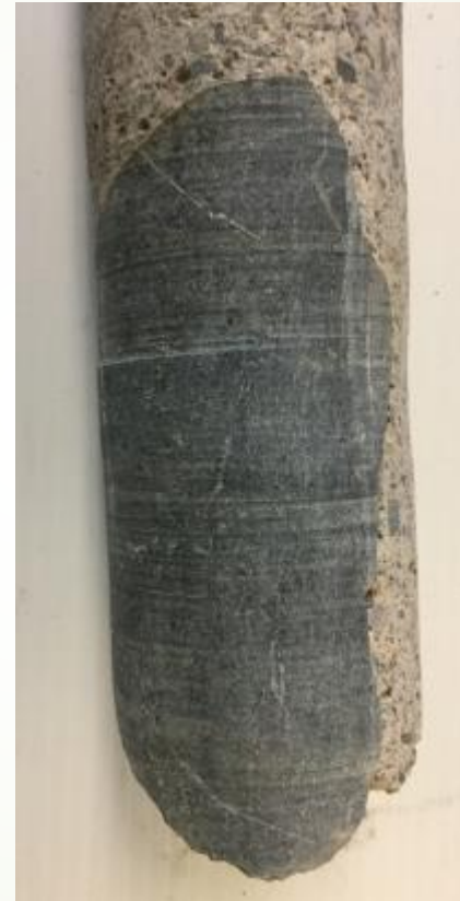
Vides d'air autour d'un granulat de 68,5 mm dans la CR-14
